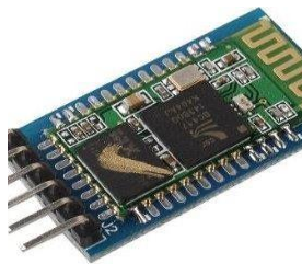
Fig. 9) HC-05 Bluetooth module
