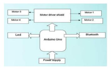
Fig-1: BLOCK DIAGRAM FOR REMOTE CONTROL TROLLEY
