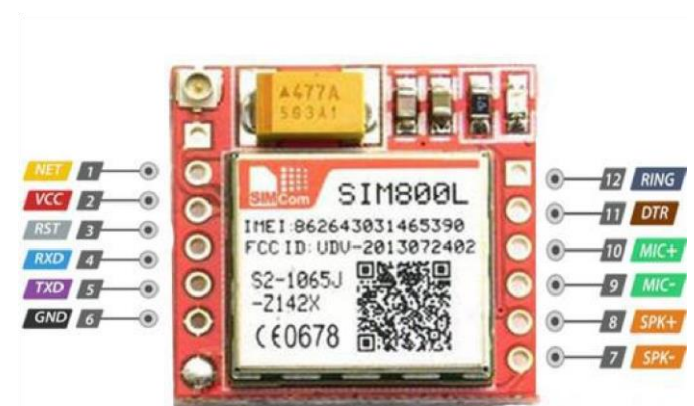
Fig:1.1.2.1 GSM Module (SIM800L)
