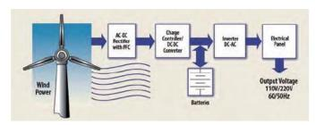
Fig. 1. WIND ENERGY GENERATING SYSTEM
