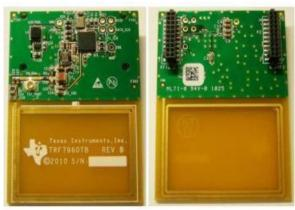
FIGURE 2- NFC module TRF7970ATB
