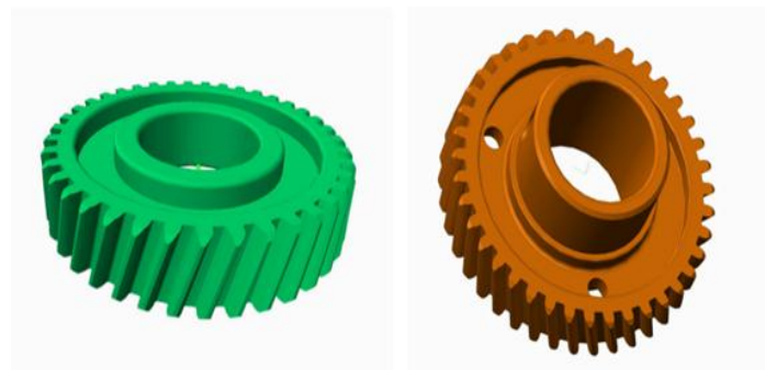
Fig-16: (c) 39 teeth small boss. (d) 39 teeth long boss.
