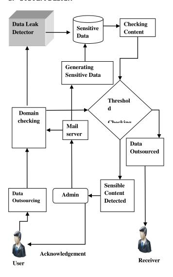
Fig 1-System Architecture
