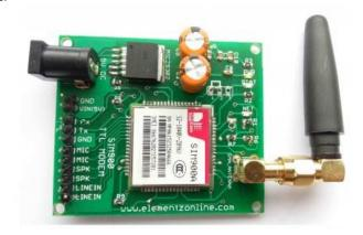
Fig: 2. SIM 900 GSM
