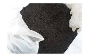
Fig.1: Copper slag
