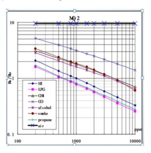
FIG-4: MQ2 GAS SENSOR RANGE
