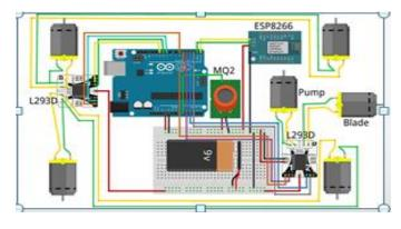
FIG-6: CIRCUIT CONNECTION
