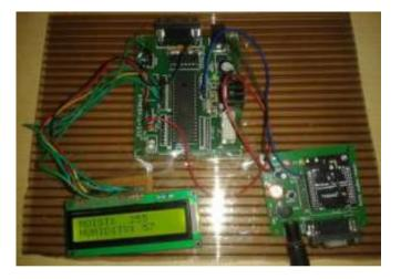
FIGURE6: RECIVER SIDE PROTOTYPE
