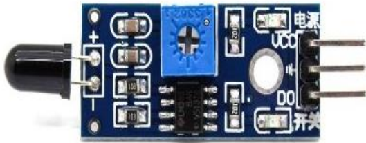
Fig -7: IR Flame Sensor
