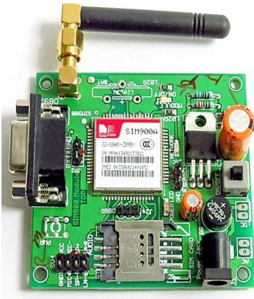
Fig -4: SIM900A Module
