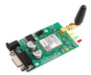
Fig-1: GSM Module
