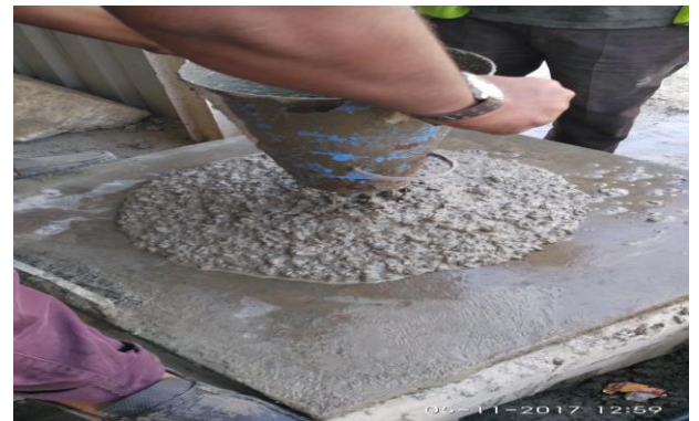
Fig-1: Flow Table Test
