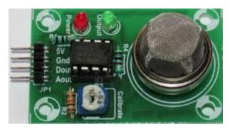
Fig. 7: MQ6 LPG GAS SENSOR
