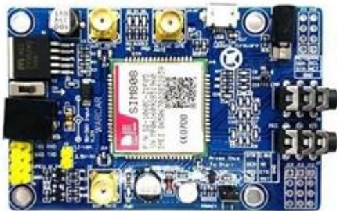
Fig-3: SIM808 GSM GPS Module
