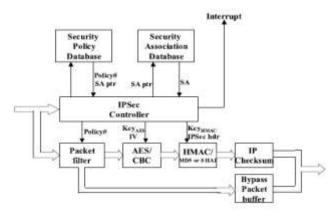
Figure1. Block Diagram.
