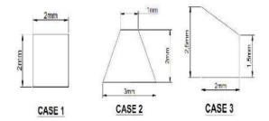
A1=2x2=4mm<sup>2</sup>A2=(3+1)/2x2=4 mm<sup>2</sup> A3=[(2x1.5)+(1x2/2)]=4 mm<sup>2</sup>
