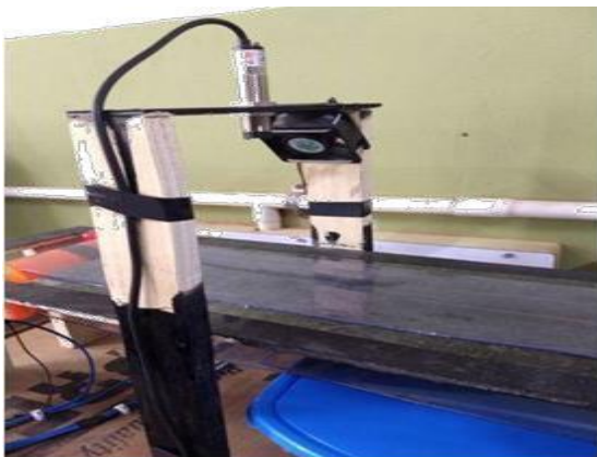
Figure4. Fan for drying
