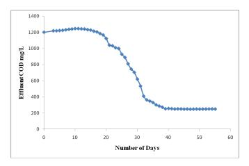
Fig. 2: Effluent COD per day
