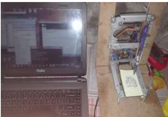
Fig. 7 Complete Wireless CNC Mini Plotter
