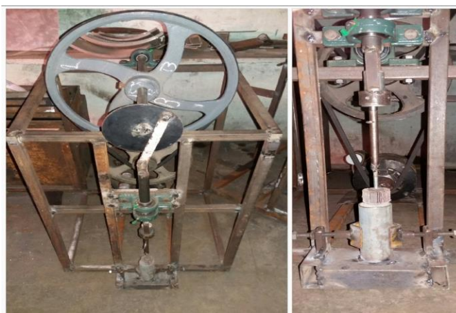
Fig 3.1 Actual set up of pipe honing machine
