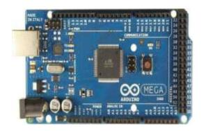
Fig.4. Arduino type-mega
