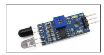
Fig. 7: IR Sensor Module
