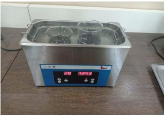
Fig.3- Ultrasonic Agitator
