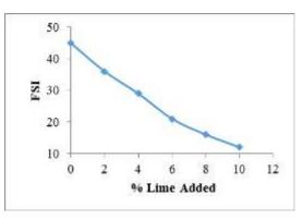
Fig. 1 FSI vs %lime
