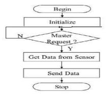
Fig-7. Flowchart of Sensor Node.
