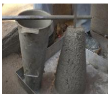
Fig. Slump Test
