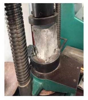
Fig.3 Split Tensile Test Setup
