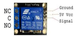
Fig. 5. Relay Pinout
