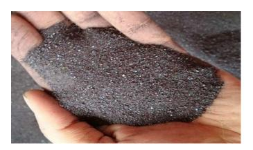
Fig -2.2 copper slag
