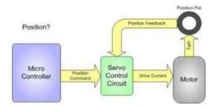
Fig-servo motor controller
