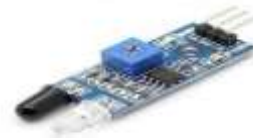
Fig-2: IR SENSOR
