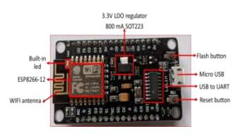
Fig-1: ESP8266 Nodemcu
