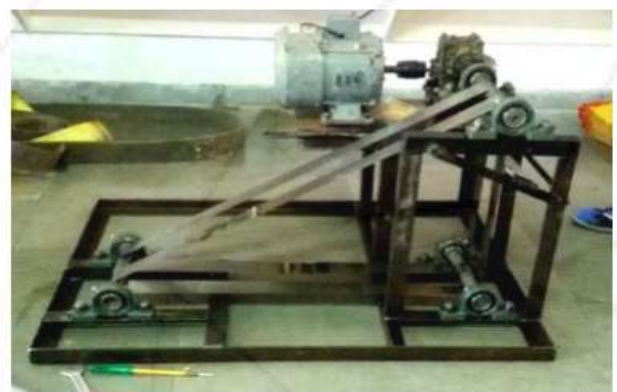
Fig-3 Actual snap of oil skimmer model
