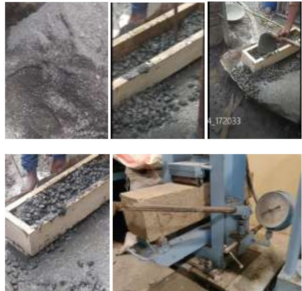
Fig -3: F. S. Test Procedure in UTM
