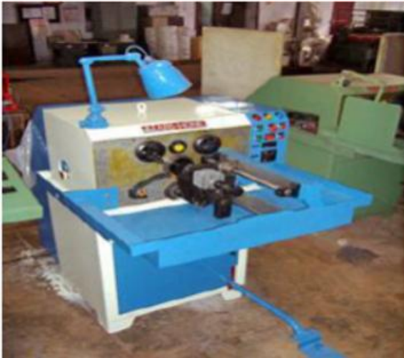
Fig -3 : Horizontal Honing Machine
