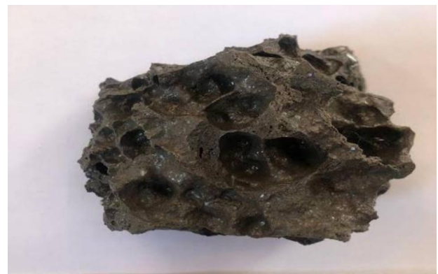
Fig-1: Blast furnace slag
