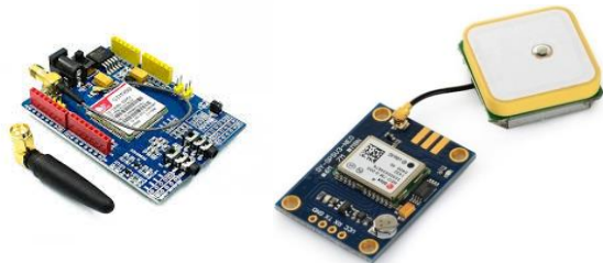
Fig 2: GSM Module and GPS Module
