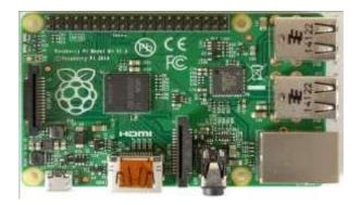
Fig -1: Raspberry pi module
