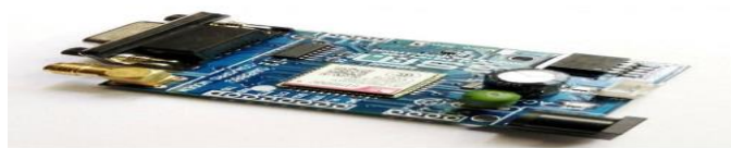
Fig 2.1.1 GSM SIM 800C Module
