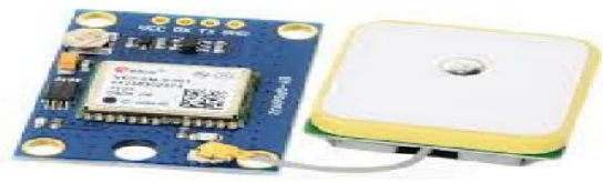
Fig 2.1.2 GPS neo-6M Modul
