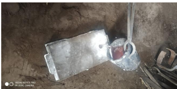
Fig: pouring the molten metal
