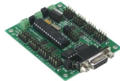
Fig: PIC controller
