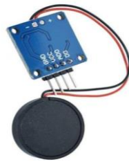
Fig-5.: Vibration sensor
