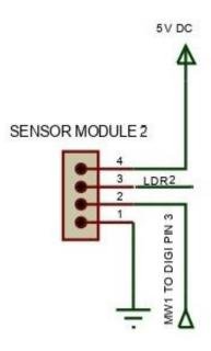
Fig -6: Module-2 pins
