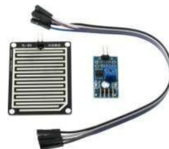
Fig: Rain sensor
